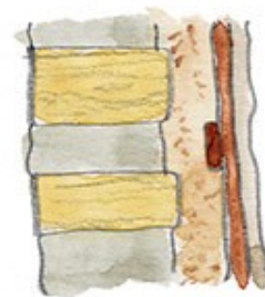
Demi-mur isolé d'un côté
